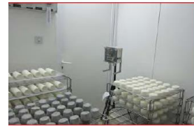
Photo 1 : prototype « saché » développé par l'INRA, mesurant en continu la température, l'hygrométrie et la teneur en gaz à proximité des fromages lors des enquêtes en ferme Source : M. Teinturier, FRESYCA
